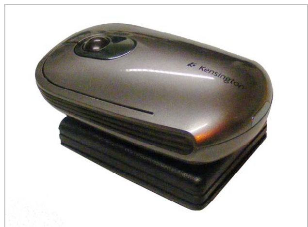
Figura 1. R^3 este compus dintr-un mouse cu funcțiile de rostogolire (roll), rotire (rotate) și scuturare (rattle) – în partea de sus – și un accelerometru cu trei axe – în partea de jos – în scopul creării unui dispozitiv cu 6 grade de libertate pentru interacțiunea în spațiu. Asamblarea și dezamblarea reprezintă un proces aproape instantaneu, care să permită o conversie rapidă într-un mouse standard și înapoi.
